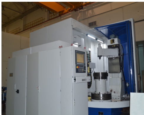
▲ 采用结合部整机性能主动设计技术开发的磨齿机
