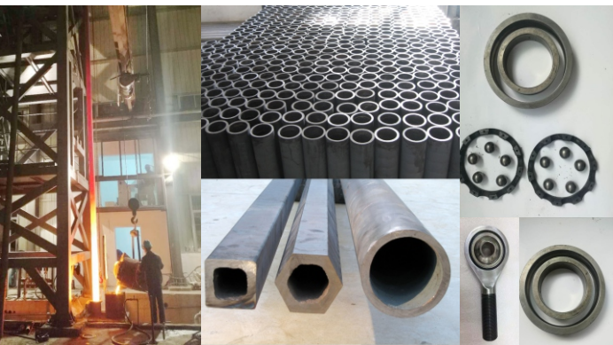
▲ 铸铁型材垂直连铸技术及产品
